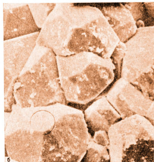
Сульфидные руды со дна океана: а — внешний вид полиметаллической руды; б — внутреннее строение пиритовой фазы руды под электронным микроскопом (увеличение около 1000 раз)
